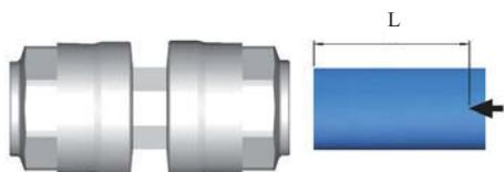
Правильное соединение трубы подтверждается положением нарисованной стрелки. Если необходимо укоротить трубу, отметьте расстояние от края трубы, на которое труба входит в фитинг.
